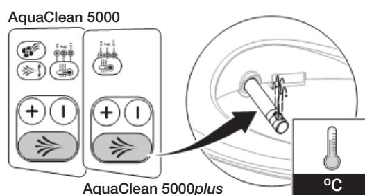
**i** Ако температурата при съхраняване или температурата на транспорт се повиши над 45 °C, се задейства предпазният термостат.
