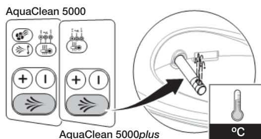
**i** Un aumento de la temperatura de almacenaje o de transporte por encima de los 45 °C activa el termostato de seguridad.
