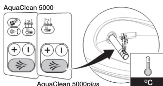
**i** Se la temperatura di stoccaggio o di trasporto sale oltre i 45 °C, scatta il termostato di sicurezza.
