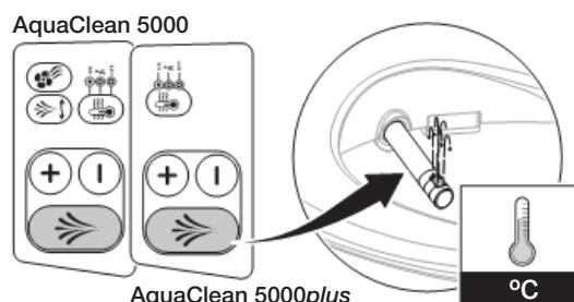
**i** Jeśli temperatura przechowywania lub transportu wzrośnie powyżej 45°C, włączy się termostat zabezpieczający.
