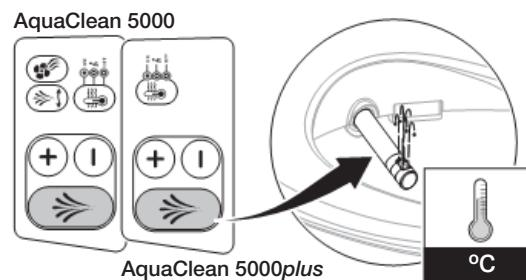
**i** Om lagrings- eller transporttemperaturen är högre än 45 °C utlöser säkerhetstermostaten.
